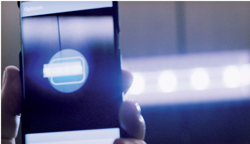
Optyczna komunikacja pomiędzy lampą smartfona a inteligentnym czujnikiem światła, zintegrowanym z wszystkimi oprawami SmartDriver, odbywa się bez użycia dodatkowej zewnętrznej jednostki sterującej.
