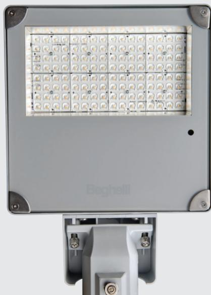
Questa fascia di apparecchi è stata testata per superare il grado di protezione IP66 e IK08, con temperature di esercizio da -20° a +40°. Il corpo lampada è stato progettato in alluminio pressofuso e acciaio per durare nel tempo. L'ampio dissipatore è frutto di simulazioni fluidodinamiche, per assicurare un'elevata vita utile dell'apparecchio.
