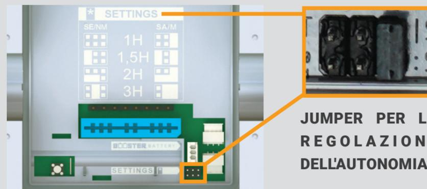
JUMPER PER LA REGOLAZIONE DELL'AUTONOMIA
