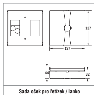
Přisazená nástěnná a stropní montáž s propojovací krabicí, čtvercový kryt
