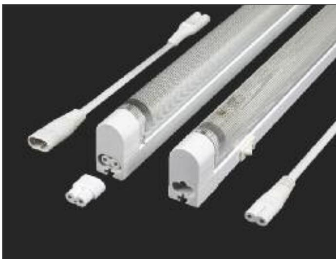
Sistema di connessione rapido con cavo di alimentazione e cablaggio passante integrato: in caso di unione di più moduli, anche di differente lunghezza, l'alimentazione è garantita da un unico cavo. Ogni modulo mantiene comunque l'accensione indipendente da quelli che lo precedono o lo seguono.
